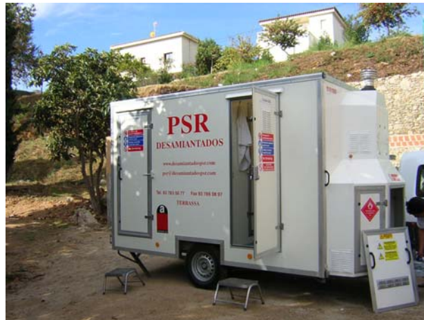
Figura 7. Unidad de descontaminación de los trabajadores
