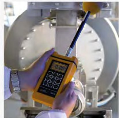
Sensore isotropico: verifica i valori di campo elettromagnetico nella zona circostante l'impianto.
